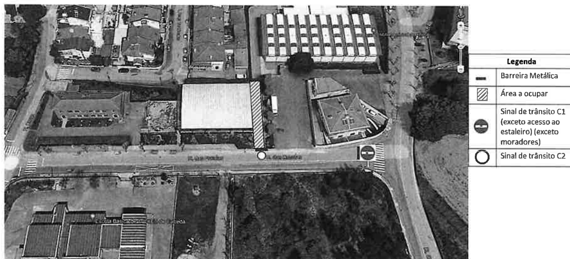
Figura 1 – Ocupação da rua de acesso às Piscinas Municipais de Alfena – Sinalização rodoviária temporária.
