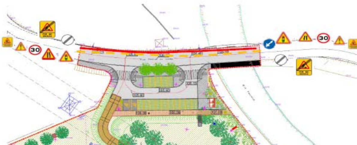
1ª intervenção – Frente de trabalho tipo – sinalização temporária obras
