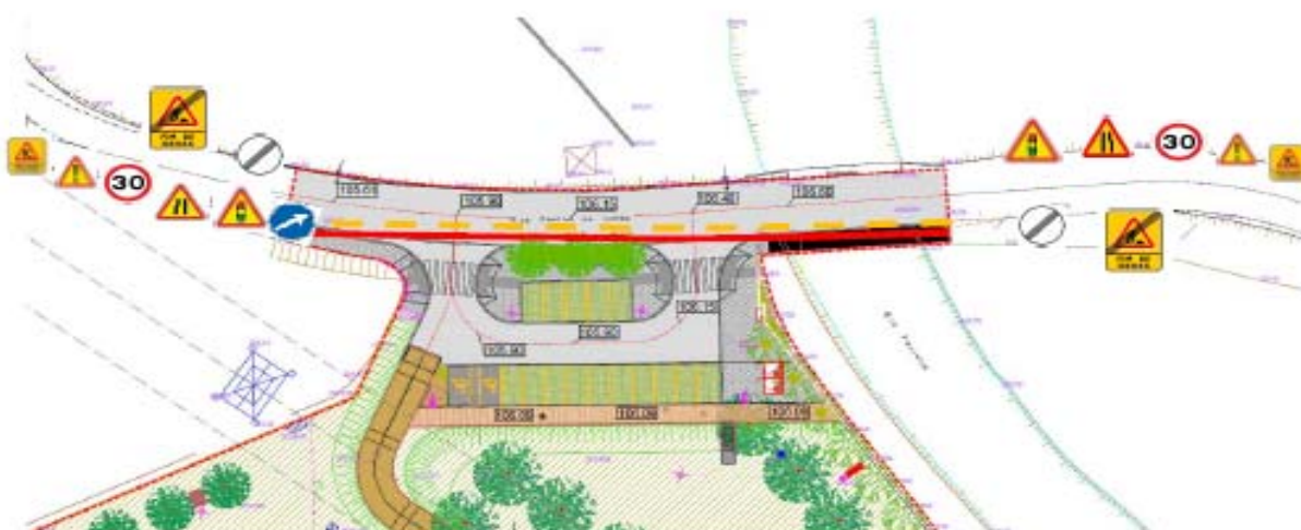
2ª intervenção – Frente de trabalho tipo – sinalização temporária obras
