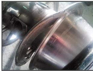
Parafuso Soldado/Equilibrado depois da Reparação
